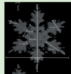
sehr präzise "Schneeflocken" (erzeugt mittels fs-Laser)
