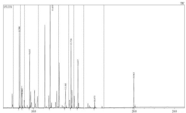
Bild 2: GC-MS-Chromatogramm (SIM) einer Luftprobe mit einer PCB-Gesamtkonzentration von ca. 1000 ng/m<sup>3</sup>
