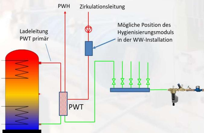
Abbildung 1: möglicher Einbauort der Hygienisierungszelle im Warmwasserkreislauf (WW), PWT: Plattenwärmetauscher, PWH: potable water hot
