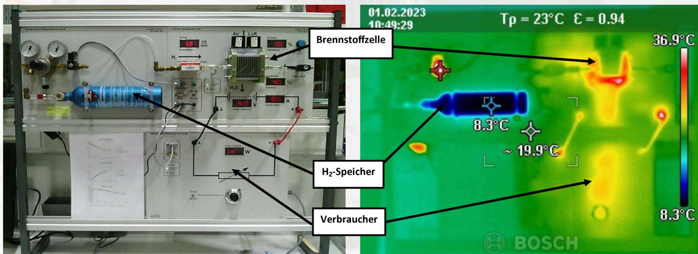
Abbildung: Versuchsstand mit einem Brennstoffzellen-Stack mit den wichtigsten System-Komponenten, aufgenommen im Bereich des sichtbaren Lichts (l.) und als IR-Wärmebild (r.).
