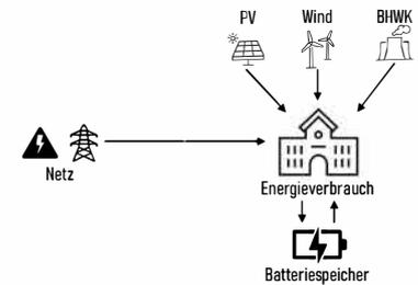
Abbildung 1: Struktur des Energiesystems der Hochschule
