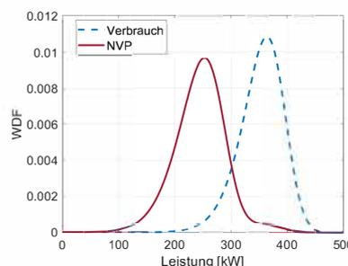
Abbildung 4: Gefaltete WDF für die Leistung am NVP
