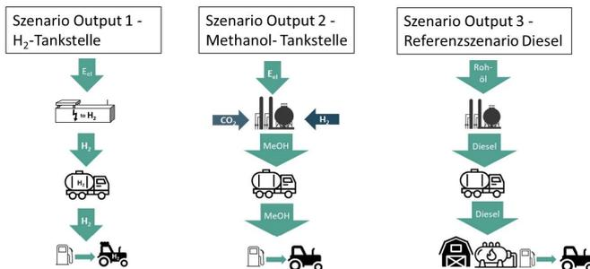
Abbildung 2: Konzeptionierung eines H<sub>2</sub>-basierten Versorgungssystems für die Mobilität in der Landwirtschaft
