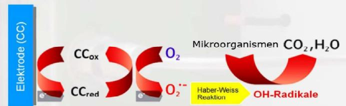
Abbildung 2: Funktionsprinzip der elektrokatalytischen Erzeugung von OH-Radikalen aus im Wasser gelöstem Sauerstoff an elektrisch leitfähigem Kohlenstoff (Conducting Carbon, CC)
